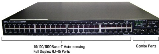
Abbildung 2-5. PowerConnect 6248P mit 48 10/100/1000-Base-T-Ports
